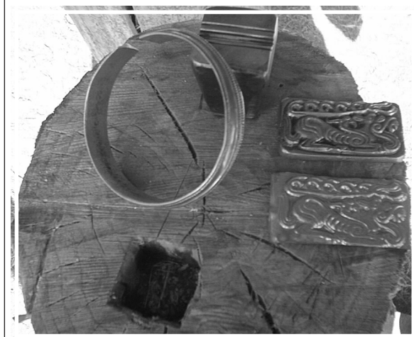
Po lewej matryca i wykonana z niej bransoletka, a po prawej patryca i wytłoczony dzięki niej wzór fot. Alicja Dużyk
